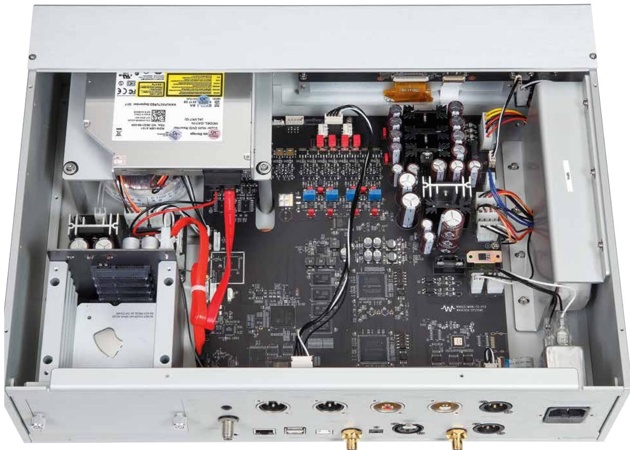
Das Innere des WNAS 3 ist aufgeräumt und kommt mit einem Minimum an Kabeln aus. An den Seiten sind die beiden Ringkerntrafos für die Analog- und Digitalsektion gut zu erkennen.
