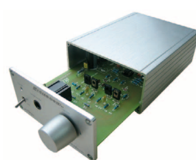
图 8 印板的安裝
